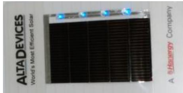
図 4 . Alta Devices 社製フレキシブル GaAs 薄膜太陽電池の室内光による青色発光 (Prof. Eli Yablonovitch 提供)
