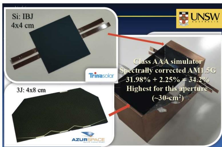
図 1 0 図 8 の光学系を用いたIII-V 3 接合セル/Siセルのタンデム構造太陽電池の特性
