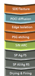
図 16 基準となる多結晶p型Al-BSFセル (Dr. M. Hermle提供)
