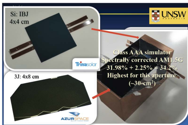
図9 図7の光学系を用いたIII-V 3 接合セル/Siセルのタンデム構造太陽電池の特性 (Prof. M. A. Green提供)
